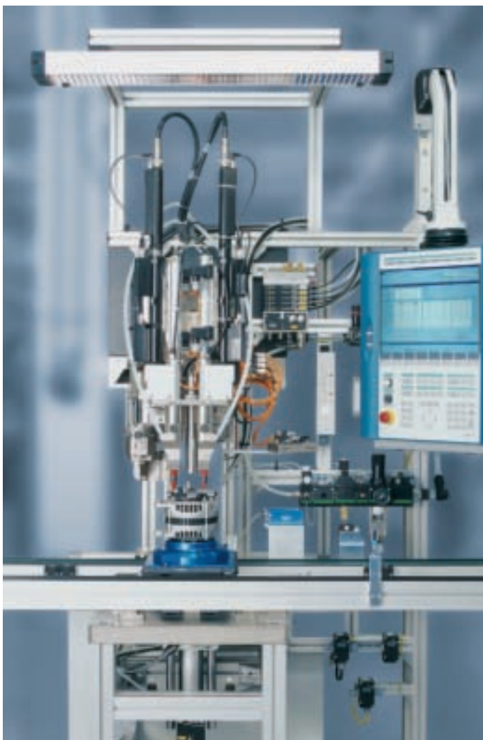
▲ Stanowisko wkrętarek do produkcji prądnic Šroubovací stanice k výrobě generátorů Csavarozó állomás generátorgyártáshoz Robert Bosch GmbH, Stuttgart, D
